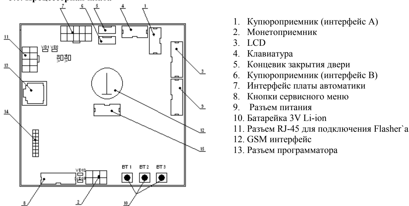
Рис. 9. Процессорная плата
